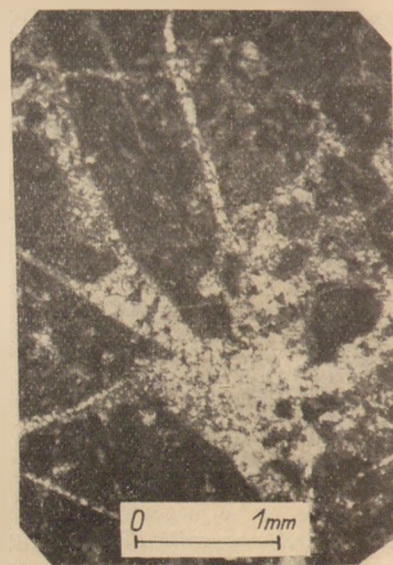
3. kép. A nagyszáli XII-7. sz. fúrás 175,0 m-ből származó mészkő vékonyseizolata
