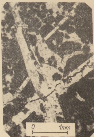
2. kép. A nagyszáli V-02. sz. fúrás 39,2 m-ből származó dolomitizált mészkő vékonyseizolata
