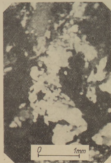
6. kép. A nagyszáli VII-04. sz. járás 27,5 m-ből származó „hárshegyi” homokkő vékonyecsiszolata
