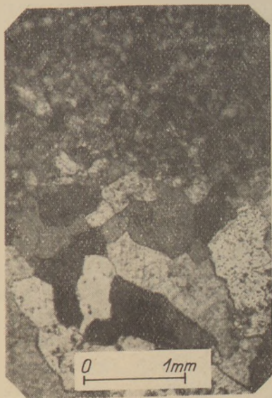
5. kép. A nagyszáli V-02. sz. járás 60,9 m-ből származó hidrotermálisan bontott mészkő vékonyecsiszolata
