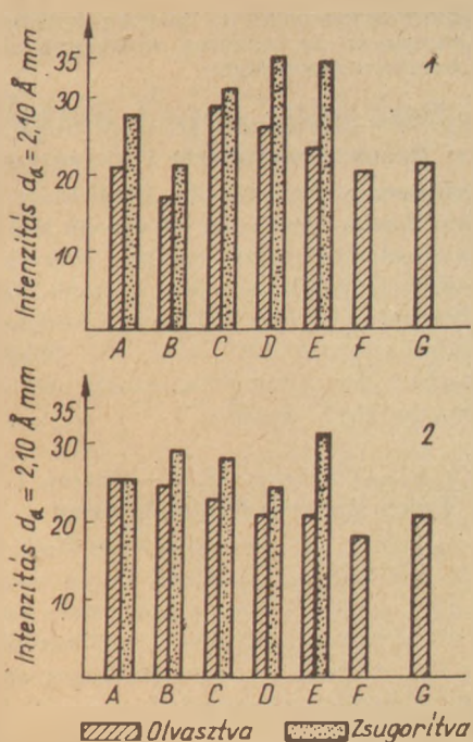
5. ábra. A periklász jellemző d = 2,10 \text{ \AA} -ös vonala intenzitásának változása az ásványi összetétellel és a hűtési sebességgel a) vízben hűtve, b) levegőn hűtve
