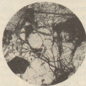
26. ábra. Szerpentinisedés. Az olivint szerpentinerek járják át. Wehrlit, Szarvaskő. (Kemenes O. felvétele)
