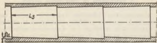
9. ábra. Lépcsőfalazás, h_s = lépcsőmagasság, L_s = lépcsőhosszúság. A kemence dőlését a lépcsőmagasságtól függően tetszőleg változtatni lehet.
