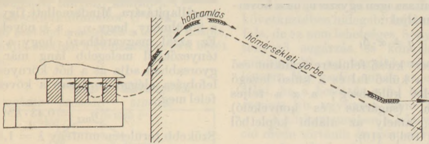
8c ábra. A hő áramlása a betét és kemence falán a hűlési periódusban
