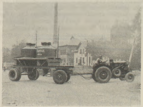
16. ábra. A nyergesújfalui Eternit Művek 5 t traktorvontatású sűrítettlevegő üritésre szerkesztett tartálykocsija.
