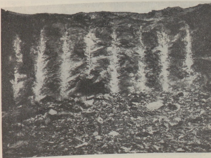
6. ábra. Nagyátmérőjű lyukakkal robbantott mészkő-sziklafal Felsőgallán.
