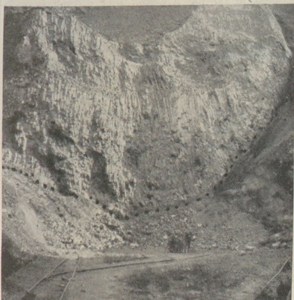
12. ábra. — Gulácshegyi bazaltbánya IV. számú bányáürege. Pontsor felől lefelé a pontusi-homok és rátelepülő bazalttufa és bazaltthátart, míg oldalt a lecsúszott homokos törlemelékthátart.
