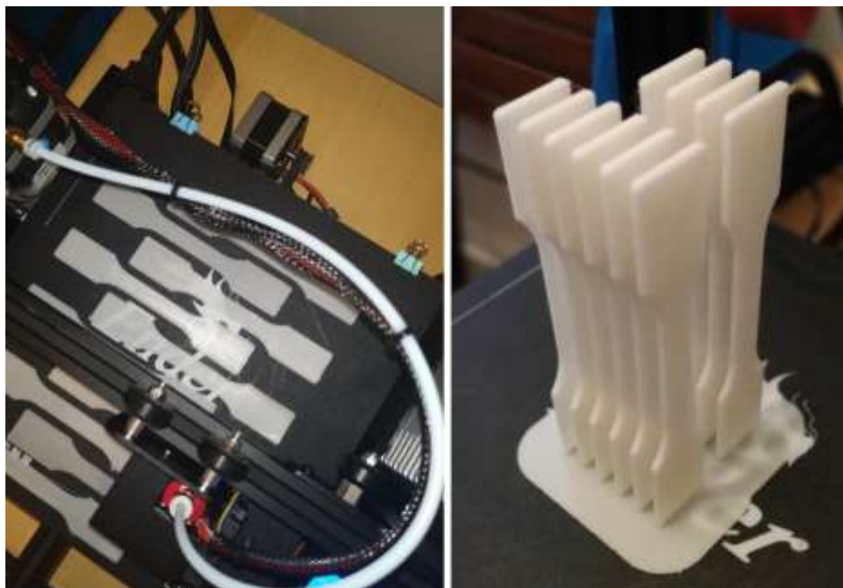
1. ábra Fekvő és álló helyzetben nyomtatott próbatestek
