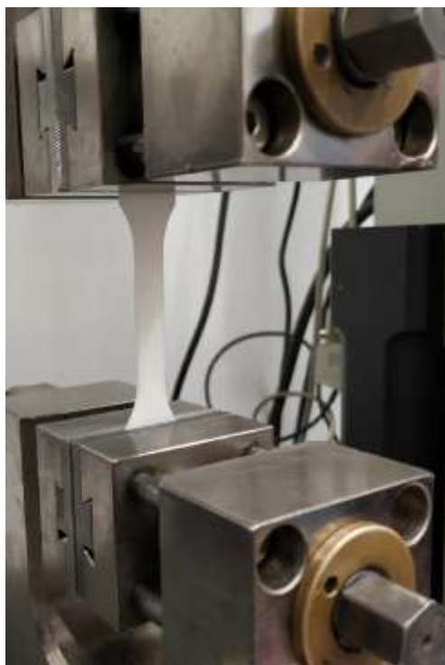
2. ábra Szakítóvizsgálat (Zwick Z005, HT-PLA, BME Polimertechnika Tanszék)
