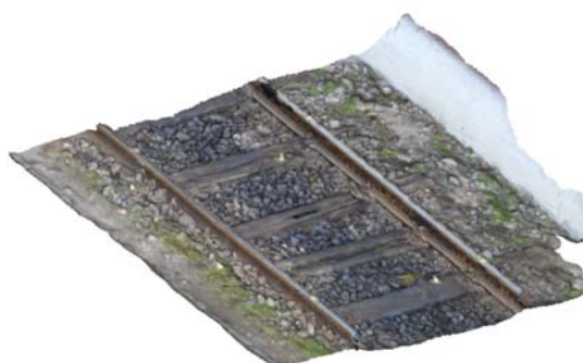
11. ábra. Egy vasúti pályaszakasz nagy pontosságú fotorealisztikus térmodellje
