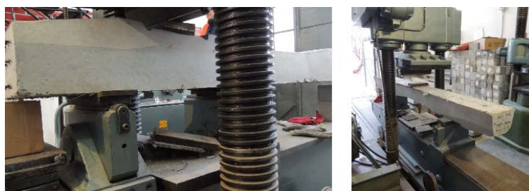
2.11. ábra. A vasúti betonlaj laboratóriumi vizsgálata [8]
