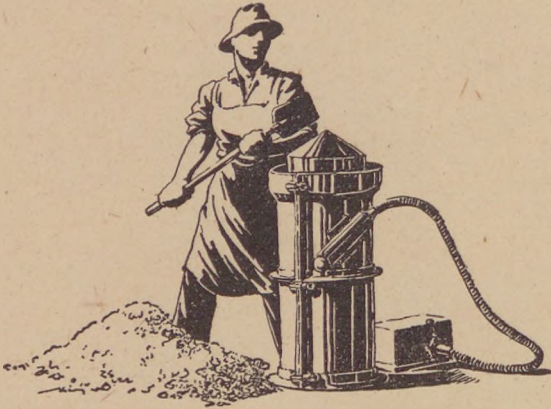
5. ábra. Csőgyártás zsaluvibrációs módszerrel
