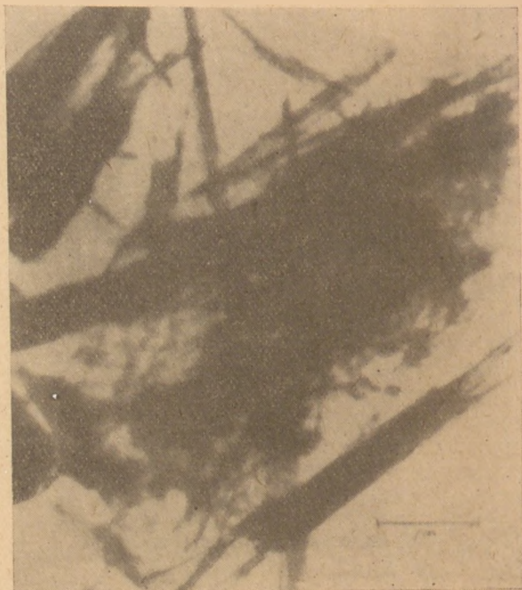
1. ábra. A mütobermonit lemezalakú kristályai. A müxonohit tűalakú kristályai (Kálonsek J. A. C. I. 1954.)
