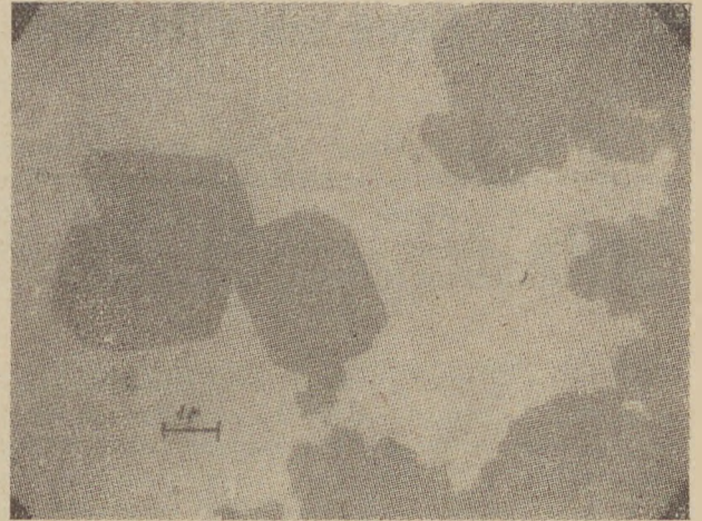
3. ábra. Cementfinomságra őrölt oltokristályok, 20 °C-on természetve
