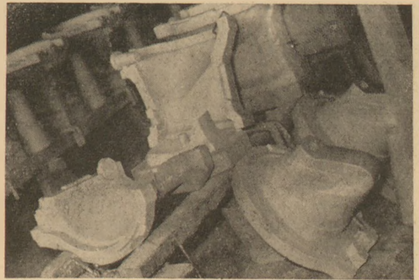
13. ábra. Szétszedett forma az öntőpadon
