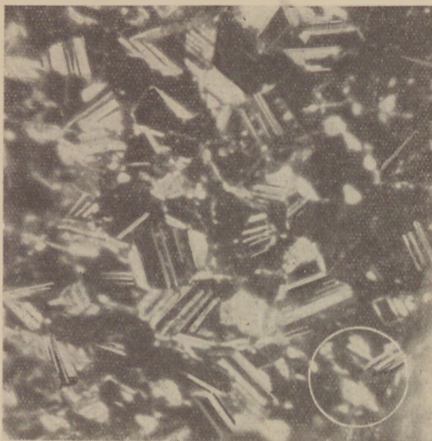
18. ábra. Az olvadék üregeinek belső felületén képződött csikozott hematit pikkelyek. \varnothing = 25\mu . Törésfelület ráeső fényben
