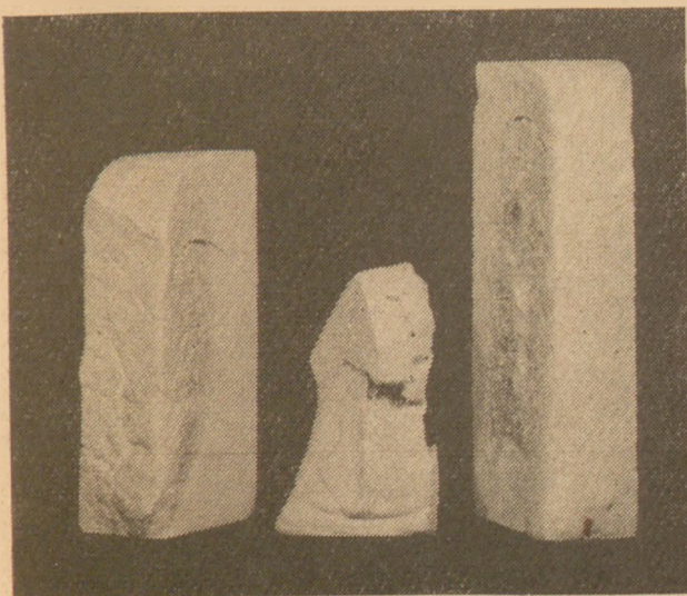
12. ábra. 1700 C°-on égetett különböző szilikatéglák. Bal — csúcsminőségű szilikatégla. Középen — kereskedelmi minőségű szilikatégla. Jobb — Tomaszow Mazowiecki-i kalcedonból készült szilikatégla
