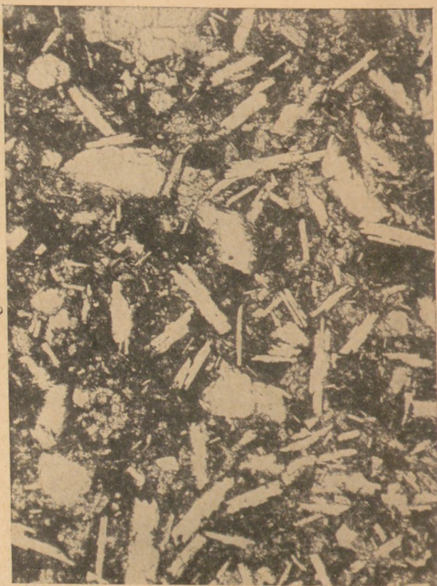
6. ábra. Kovácsi-hegy fekete bazaltja II. sz. mélyfúrás 50,3—51,3 m-es szakaszáról. (Nagyítás 40-szeres)
