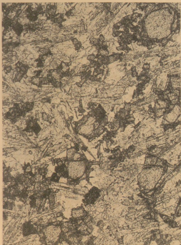
7. ábra. Kovácsi-hegy szürke bazaltjának mikrofotografikája. (Nagyítás 40-szeres)
