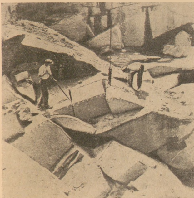
7. ábra. Kőfejtés ékeléssel a Slavina gránitbányában [9]
