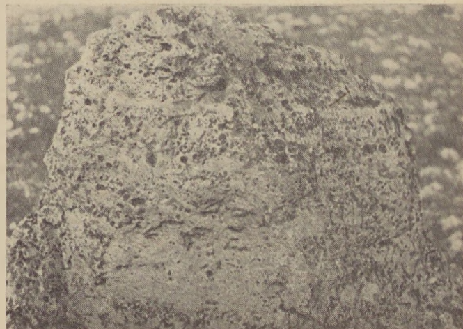
2/b ábra. „Darázskő”, riolittufa, melyből a horzsakő-szemcsék kihullottak
