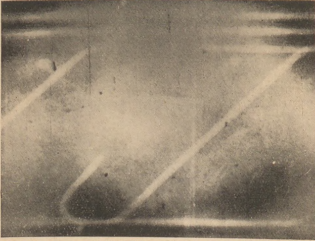
6. ábra. Vb. gerendáról 75 cm távolságból készült felvétel
