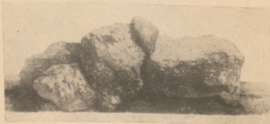
11. ábra. A vízhűtéses kemencéből származó védőkéreg
