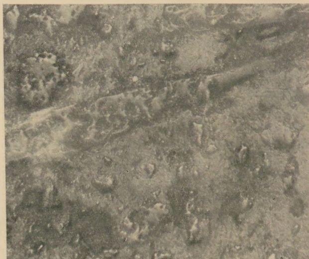
1. ábra. 7 éves lemez. Korrodált üvegszál („lyukasodás”) Nagyítás 400×
