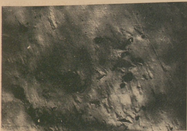
7. ábra. Szilíciumkarbid szemcséfelület elektronmikroszkópos felvétele. (10 800 ×)
