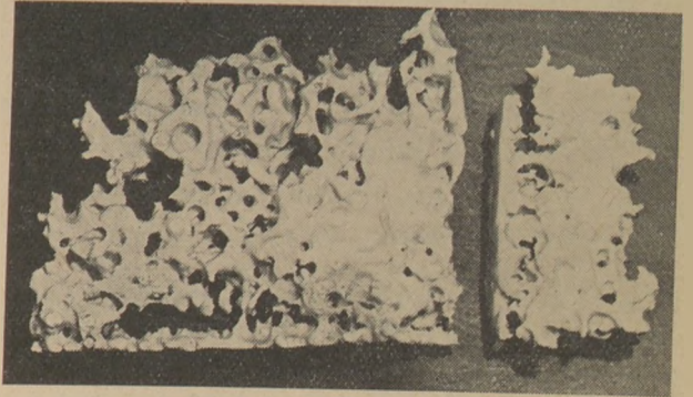
5. ábra. 100 mm vastag Korvisit fenéklapok elhasználódása 50 hónapos üzemelés után
