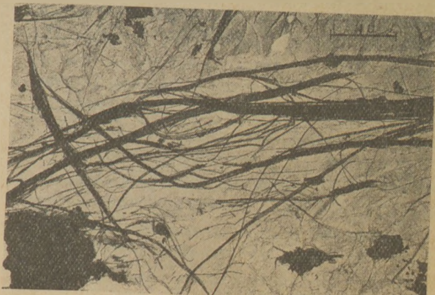
7. ábra. 1954. évi tetőfedőlemez elektronmikroszkópi képe. (6000-szeres nagyítás)
