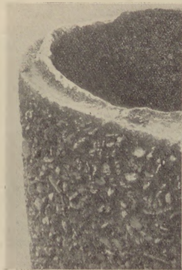
1. ábra. Csatornacsövön észlelt savas korrózió (Hummel felv.).
