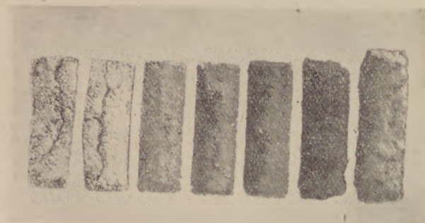
10. ábra. Azonos készítésű különböző töménységű \text{MgSO}_4 oldatba helyezett próbatetek korróziója (Kind felvétele)
