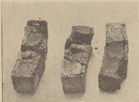
5. ábra. ÉTI vizsgálata 4 × 4 = 16 cm méretű próbatestekkel
