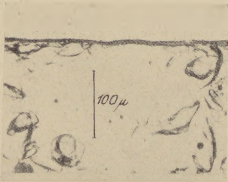
7. ábra. A mázrétegen fekvő aranyrétegről készült mikroszkópi keresztcsiszolat
