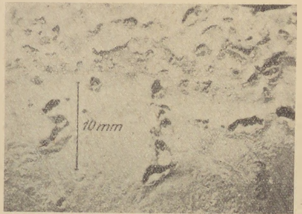
4. ábra. A máz egyenetlenségei miatt kráteressé vált aranyfelület
