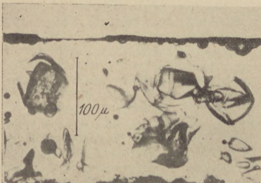
8. ábra. Mikroszkópi keresztcsiszolat az aranyozott mázas felületről. Az aranyozás egyenetlen rétegben követi a máz felületét. A mázban számos feltáratlan kvarcsemese van
