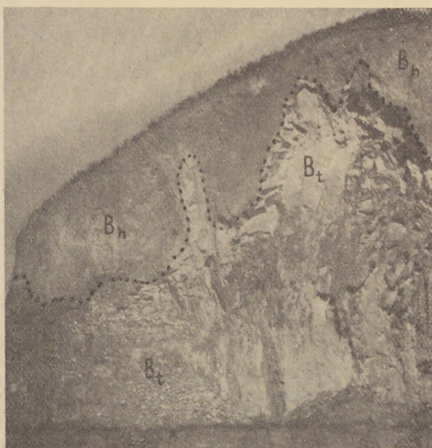
15. fénykép. A Badacsony—tördemici bányában a meddő letakarás és a használható bazalt aránya: Bh = hólyagos, Bt = tömött bazalt.
