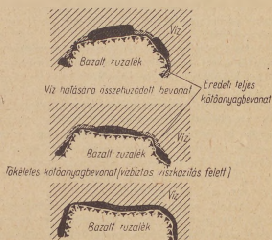
5. ábra. Hígított bitumen tapadása zúzalék felületén víz jelenlétében
