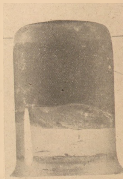
6., 7., 8. és 9. ábra. Mészhidrát túladagolás hatására tönkrement duzzadó cementtestek
