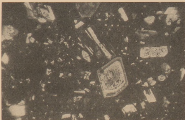
15. ábra. Jó minőségű andezittufa mikroszkópi képe (a téglalap valóságos hossza 2,5 mm)
