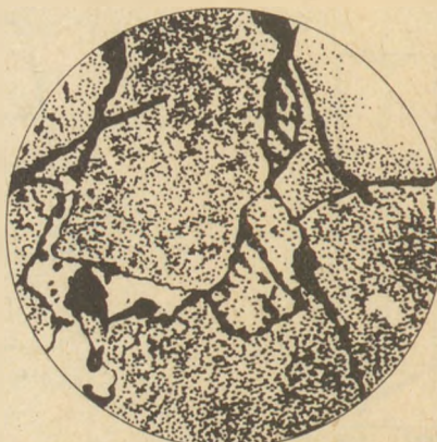
7. ábra. A tömb alsó része (10). Kalciumhexaalumínát aggregátumok a korundkristályok csatlakozásainál fehér titánkarbid beágyazásokkal. Visszavert fényben 125×
