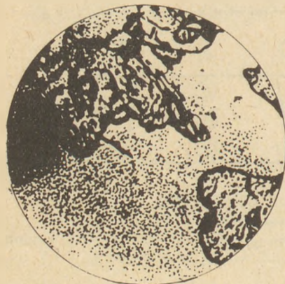
6. ábra. A tömb oldala (4). Korund és kalciumhexaalumínát aggregátumok, oxigénmentes titánvegyület beágyazásokkal (fehér). Visszavert fényben 125×
