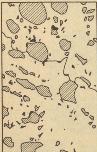
9. ábra. a) A kalciumhexaalumínát kristályok jellegzetes alakjai. b) A korundkristályok jellegzetes alakjai
