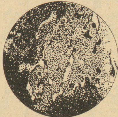
5. ábra. A tömb felső része (1). Dendrites korund (sötét-szürke), kalciumhexaaluminát (világosszürke) és oxigénmentes titánvegyület beágyazások (fehér). Visszavert fényben 125×
