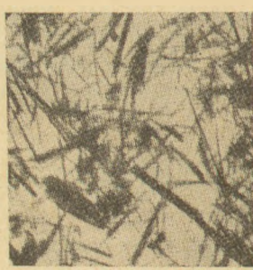
5. ábra: A jól kristályosodott tobermorit táblák xonotlit tűkké való átalakulását mutató elektronmikroszkópi felvételek
