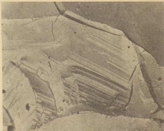
17. ábra. Ömlesztett korundkő tűzállóanyag felületének elektronmikroszkópos képe vízüveg-olvadék hatására
