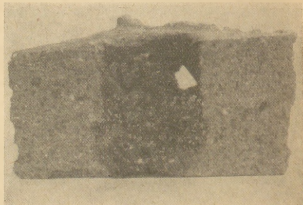
3. ábra. Eisenbergi AII samott korrozója
