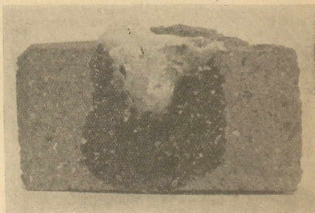
2. ábra. Eisenbergi K 60 jelű samott korrozója
