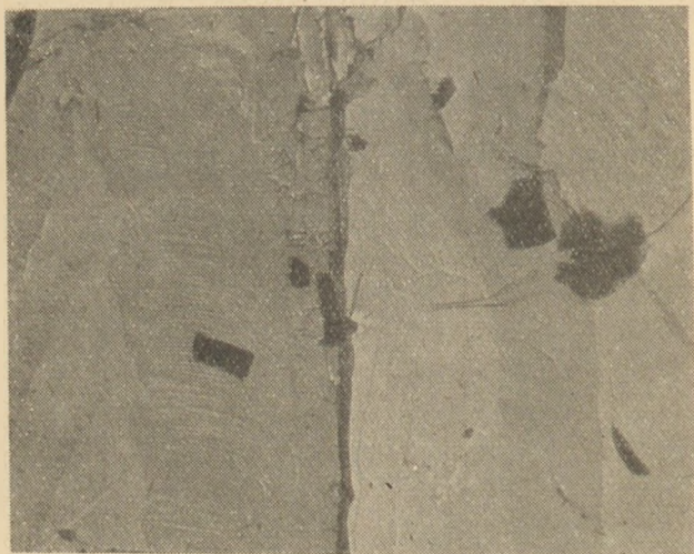
16. ábra. Ömlesztett korundkő tűzállóanyag felületének elektronmikroszkópos képe
