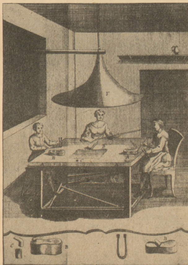
1. kép. Üvegfúvó asztal és szerszámok. Kunckel J. Ars nitraria experimentalis c. művéből
