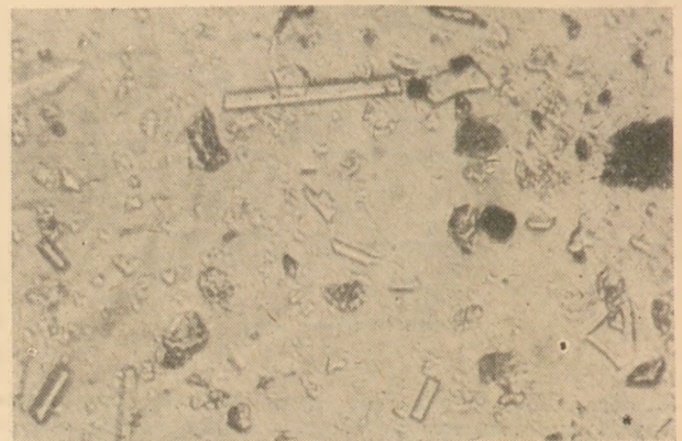
8. ábra. Szintetikus mullit poráról készült mikroszkóp felvétel. Nagyítás 135-szörös. Elvétve korund lemezek láthatók
