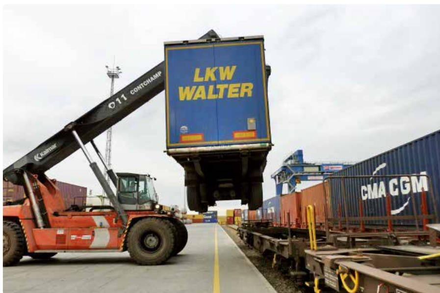
2. ábra. Daruzható félpótkocsi vagonba emelése • Forrás: Vállalati belső anyag, 2015
