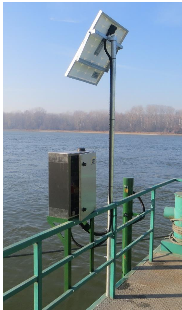
2. kép. Távjelzős zavarosságmérő állomás (Duna, 1479,6 fkm, bal part, szerző fényképe) Photo 2. Automatic turbidity monitoring station (Danube, 1479,6 rkm, left bank, author's photo)
