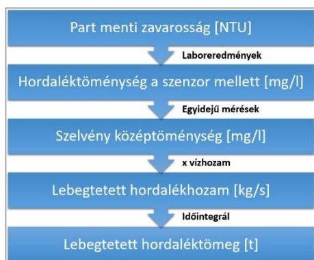
1. ábra. Lebegtetett hordalékhozam meghatározása zavarosság alapján ( Habersack és társai 2019b, a szerző fordítása ) Figure 1. Determination of the suspended sediment load based on turbidity ( Habersack et al 2019b, translated by the author )
