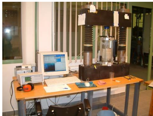
2. kép. Triaxiális vizsgáló berendezés a Miskolci Egyetem Geotechnikai Talajvizsgáló Laboratóriumában (Fotó: Kántor) Photo 2. Triaxial cell in the Geotechnical Soil Testing Laboratory (Photo: Kántor)
