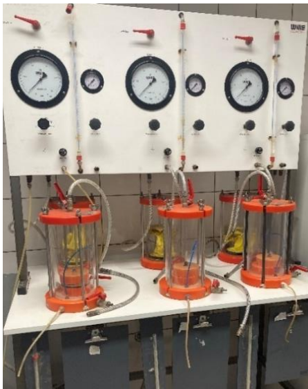
1. kép. A finomszemcsés anyagok szivárgási tényezőjének mérésére használt flexibilis falú permeabiméter (A szerzők saját felvétele)
