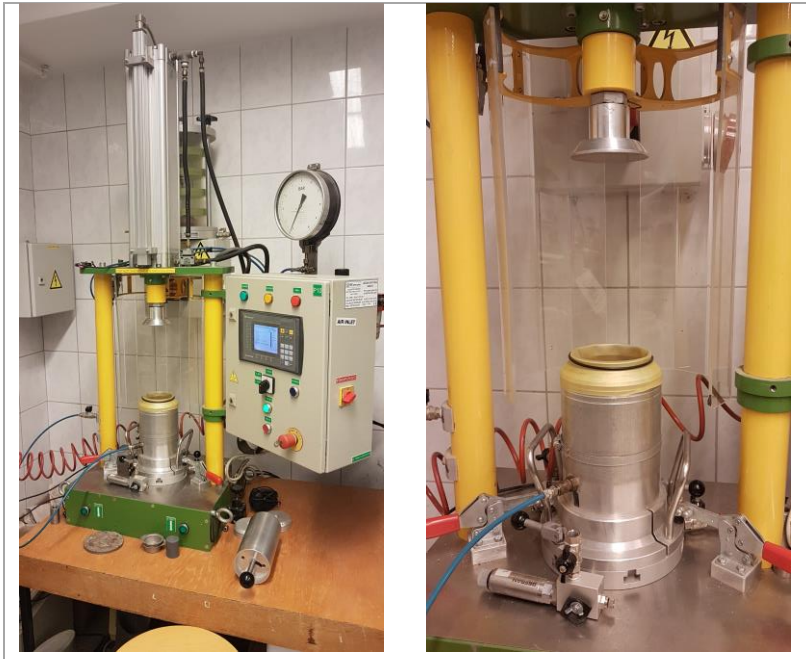
1. kép. Innovatív mintatömörítő berendezés (Fotó: Kántor) Photo 1. Innovative soil sample preparator machine (Photo: Kántor)
