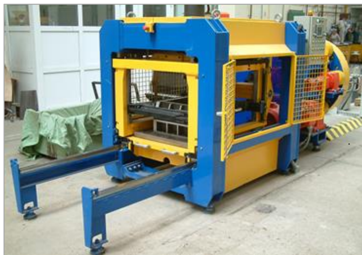
3. kép. Nagyméretű direkt nyíróberendezés (Fotó: Kántor)
