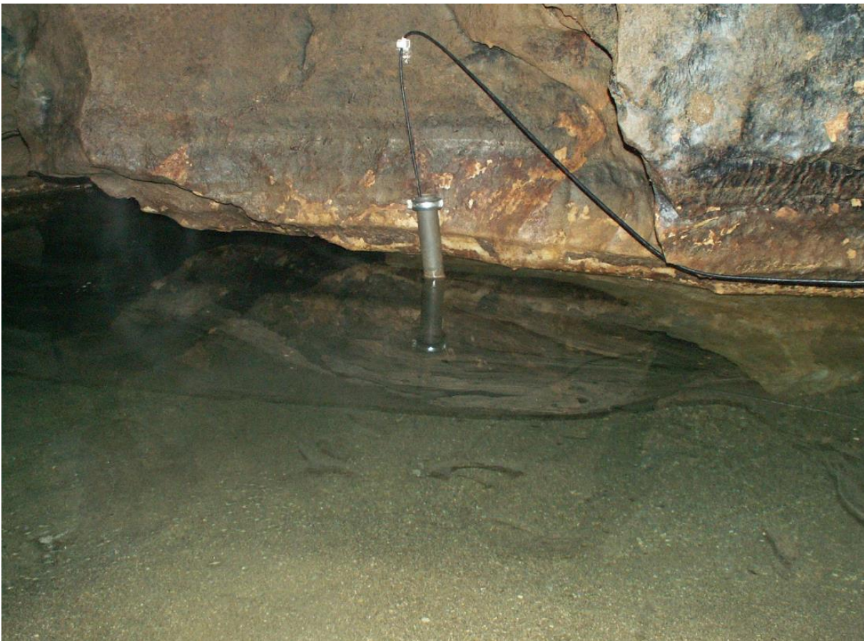
Vízszint és vízhőmérséklet mérés az István-lápai barlang (Bükk hegység) 2. sz. szifontavában (Fotó: Juhász)
