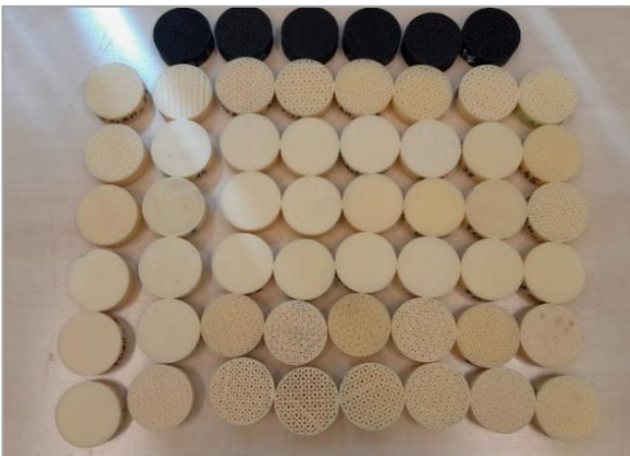
2. kép. A laboratóriumi szivárgási tényező mérésekhez nyomtatott mintatestek (A szerzők saját felvétele 2022)
