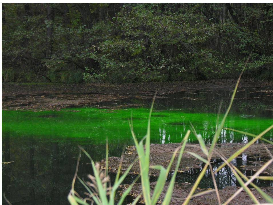
Forrásfakadási helyek víznyomjelzések vizsgálata Tatán, a Fényes-források területén, a Sarki-forrás tóban (Készítette: Lénárt)
