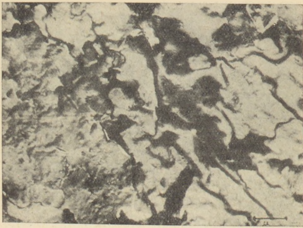
16. ábra. Elektrokorund szemcse szövege forgácsolás után, 12 100 ×
