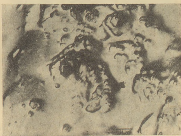
14. ábra. A felületi tagoltságot jól követő, vékony kötőanyagburokkal bevont szemcséfelület, 13 200 ×
