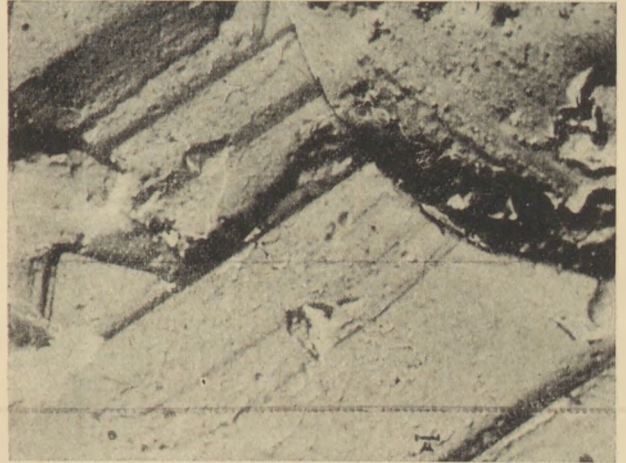
2. ábra. Szöveti szemcsék az elektrokorundban 42 400×
