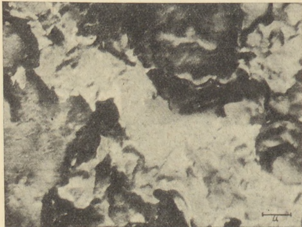
17. ábra. Forgácsolás során meglágyult korundkristály felülete, 12 100 ×
