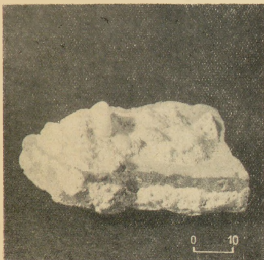
3. ábra. A cserép mészhabarcos törésfelülete
