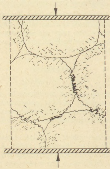
8. ábra. Fecskefark-kristályok képződése nyírófeszültség hatására (Borchert, 1959)
