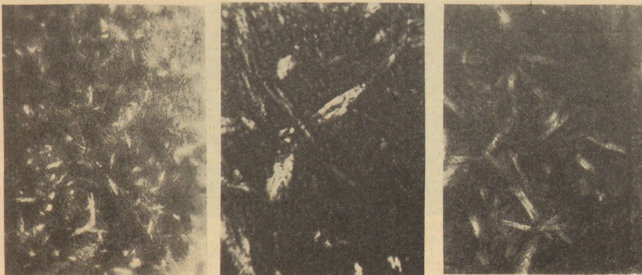
12. ábra. Vitrokerámiai anyag mikroszkópi felvétele 400, 1000 és 2000-szeres nagyítással
