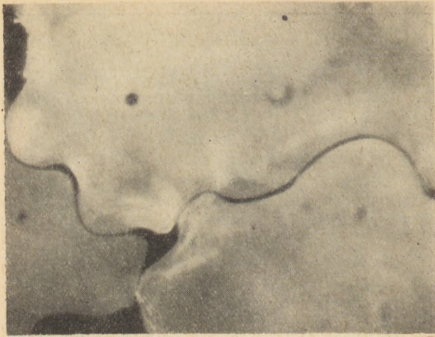
4. ábra. Mésszel stabilizált cirkónium-oxid fényezett, nem maratott csiszolata visszavert fényben
