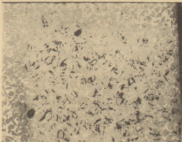
2. ábra. Közvetlen kötésű szilícium-karbid anyag fényezett csiszolata visszavert fényben
