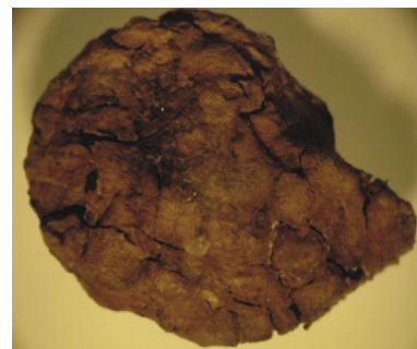
Fig. 2 Microscope view of cork granulate 3/8. 40X 2. ábra Parafagranulátum mikroszkóp alatt (3/8. 40X)
