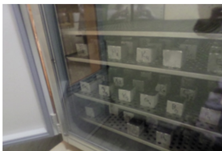
Fig. 3 The accelerated carbonation chamber 3. ábra A karbonátosodás gyorsító kamra
