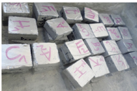
Fig. 4 Samples sawn in half before spraying with phenolphthalein 4. ábra A félbevágott minták a fenolftalein felhordása előtt
