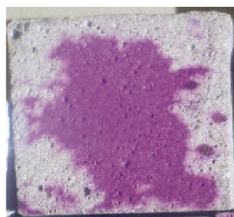
Fig. 7 MSD mortar after 56th days in accelerated carbonation chamber 7. ábra Az MSD habarcs 56 napnyi gyorsított karbonátosodási kamrában töltött idő után
