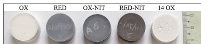
Fig. 2 The pressed samples after the pre-sintering and sintering processes 2. ábra A préselt minták az elő-szinterelési és szinterelési folyamatok után
