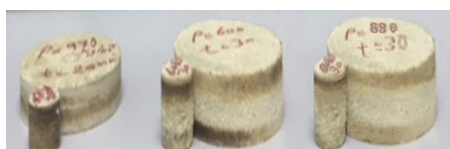
Fig. 5 Samples cut to circular shapes (100, 28 mm) 5. ábra Henger alakúra vágott minták (100 ill. 28 mm átmérő)
