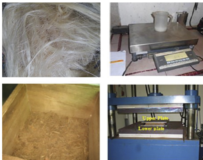
Fig. 2 Processes of manufacturing the composite sample 2. ábra A kompozit anyag előállításának folyamata
