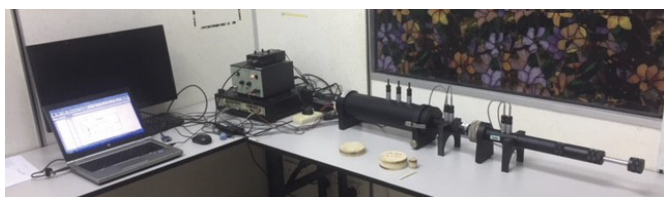
Fig. 6 Impedance tube instrument and setup system 6. ábra Impedancia meghatározására használt kísérleti összeállítás
