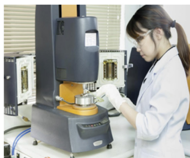
Fig. 2 Rheological study of the curing process of a water-based epoxy with polythiol additives using a rheometer 2. ábra Víz alapú epoxi politiol-adalékanyagokkal való kezelési folyamatának reológiai vizsgálata reométer segítségével
