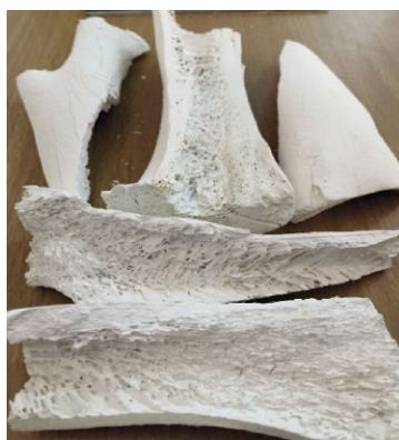
Fig. 3 Bovine bone after calcination process 3. ábra Szarvasmarha csont meszesítési eljárás után
