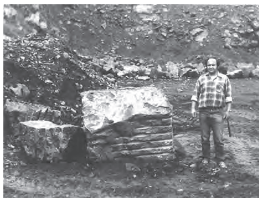
11. ábra Hasítással szabályosra formált gabbrotömb Fig. 11. Regular shape gabbro block after split processing
