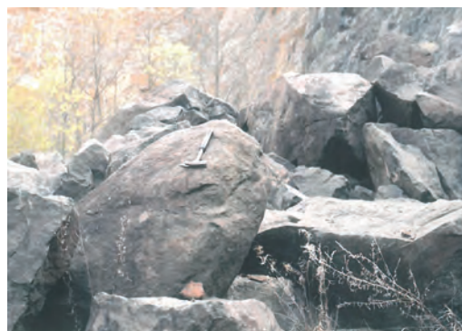
14. ábra A több évtizedes felszíni mállás hatása a gabbrótömbökön Fig. 14. Influence of several decades' weathering on the gabbro blocks
