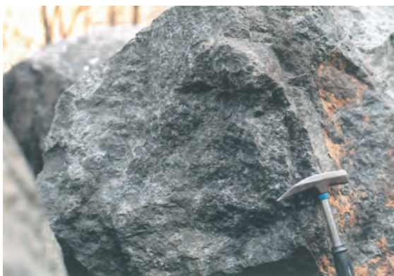
5. ábra A gabbró friss törési felülete Fig. 5. Fresh fracture surface of gabbro
