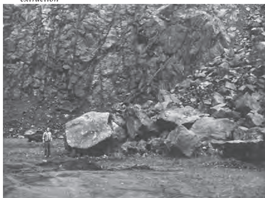
9. ábra Gabbrotömbök a lerobbantott kőzethalmazban Fig. 9. Gabbro blocks in the debris after explosive extraction
