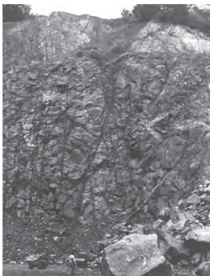
7. ábra Változó sűrűségű és erősségű törések a bányauzem délkeleti bányafalán Fig. 7. Various density and intensity fractures on the southeast pit wall of the quarry
