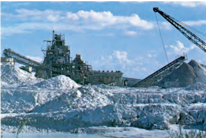
Fig. 6. Disposal of quarry crushed sand to the ground (CS) 6. ábra Zúzott bányahomok deponálása
