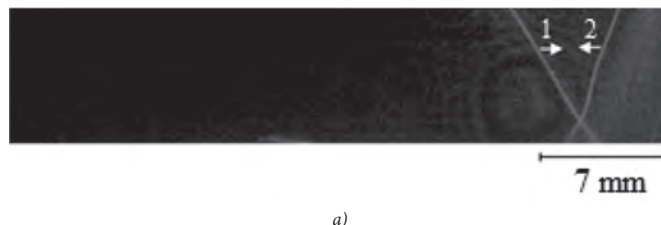
Fig. 4. Propagation of Chernov-Lüders band in 301 AISI material: a) visualization of Chernov-Lüders band propagation, b) kinetic diagram 4. ábra Chernov-Lüders szakasz előrehaladása 301 AISI anyagban: a) A Chernov-Lüders szakasz előrehaladásának megjelenítése, b) kinetikus diagram
