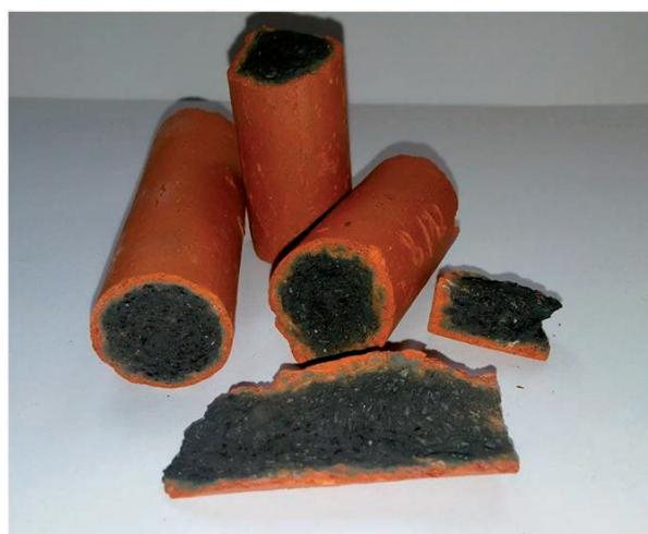
Fig. 1. The cross-section of fired and cracked specimens 1. ábra A kiégetett és eltört próbatestek keresztmetszete
