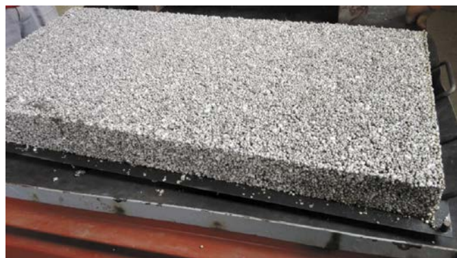
5. ábra Az elkészült geopolimer-EPS kompozit próbatest [18] Fig. 5. A geopolimer-EPS composite specimen
