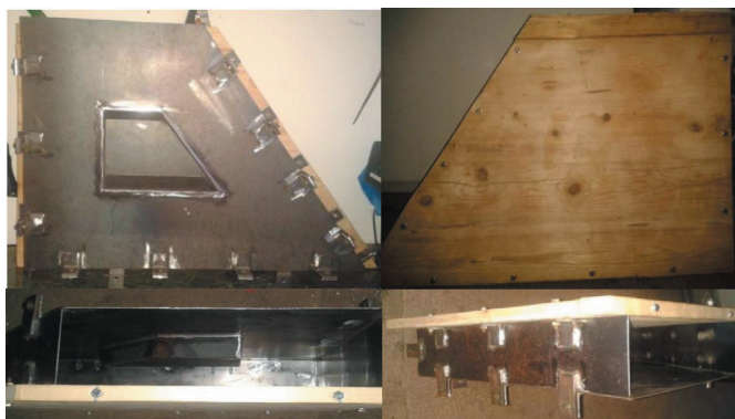
Fig. 2. The applied form liners 2. ábra Az alkalmazott zsaluhéjak
